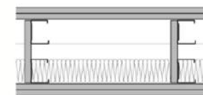
Figura 27 – Colocação da lâ de rocha em paredes com dupla estrutura ligada – fonte: Manual de projeto e sistemas de drywall – Fonte: Associação Drywall
