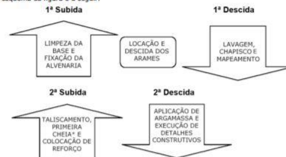
Figura 3 - Esquema de subidas e descidas dos balancins.
